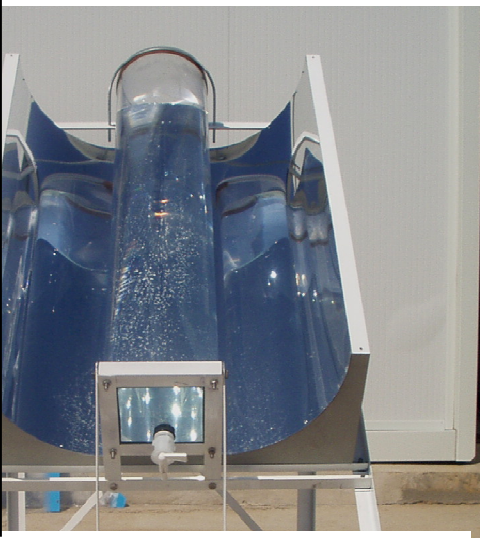
SODIS-CPC reactor – 25 litres
